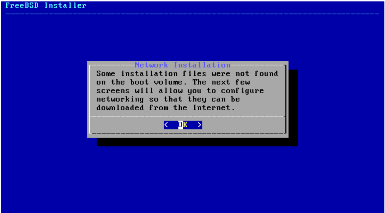
Figura 9. Instalando a partir da rede
